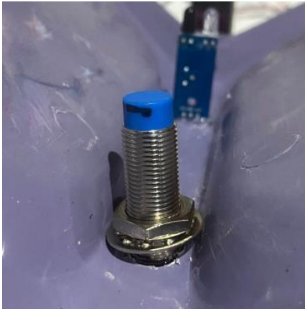
Gambar 15. Pengujian Terhadap Sensor Metal Proximity LJ18A3
