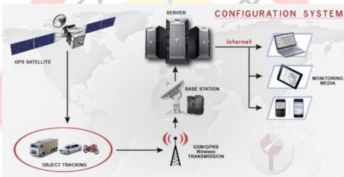
Gambar 2. 2 Cara Kerja GPS
